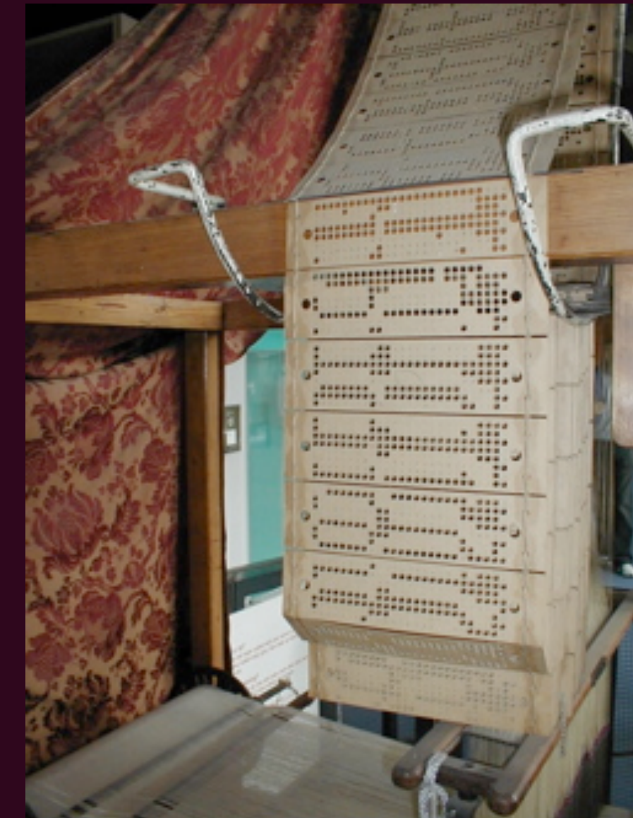
雅卡尔织布机: 通过打孔卡片控制织出的图形
